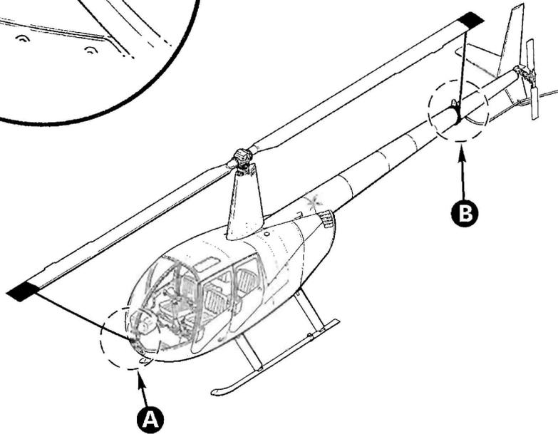
WRAP AROUND TAIL CONE IN FRONT OF LIGHT, AROUND TAIL CONE TO BACK OF LIGHT; THEN WRAP AROUND BASE TO ATTACH VELCRO.
